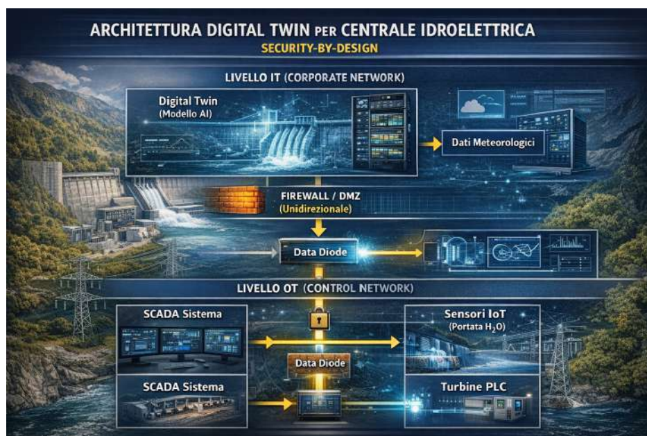
Figura 2 - Architettura del Digital Twin con segregazione IT/OT
